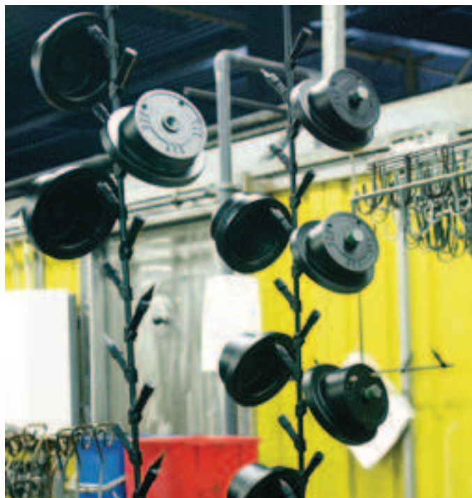
Durch den Einsatz der Längsträgergestelle wurde die Behängungsdichte um den Faktor 4 erhöht. Quelle: Redaktion
