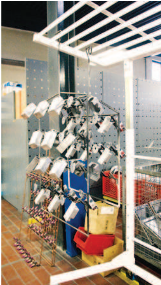
Vorhängewagen erlauben die effiziente Werkstückaufhängung vor der Aufgabe in den Kreiskettenförderer. Quelle: Redaktion
