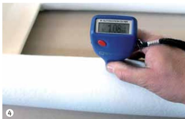
Figura 4: Misurazione dello spessore del rivestimento con lo spessimetro Automation Dr: Nix, distribuito in Italia da Tecno Supply.
